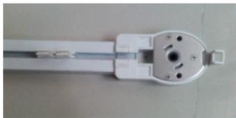
4. 剪掉8格带齿后装上滑块配件，测试滑动是否顺滑，顺滑后拆下传动箱齐同步带两端，拆掉传动箱盖，在同步带中点处标示。
