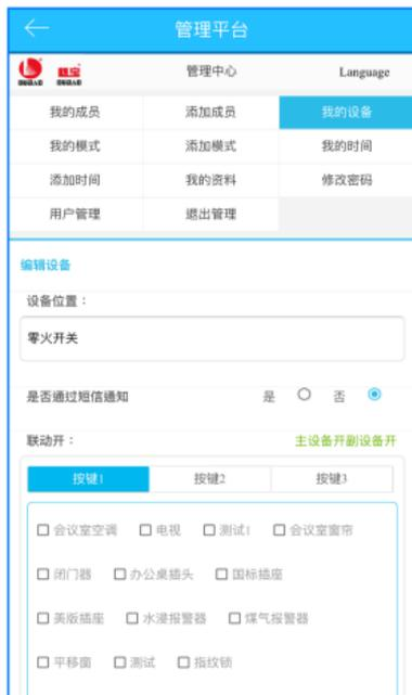
1. 进入“管理平台”，选择“我的设备”，点击单火触摸开关或零火触摸开关“编辑”按钮。
