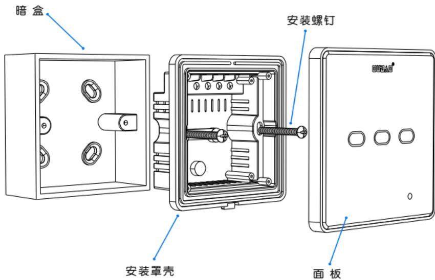
触摸开关安装示意图
