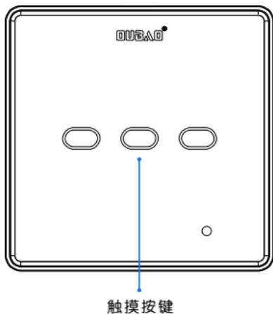
**配置：**长按触摸开关中间的触摸按键5秒以上，直至蓝色WIFI指示灯闪烁，则设备进入“配置”状态。
